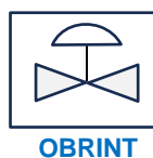
Figura 8-7: Vàlvula en moviment en mode automàtic .
